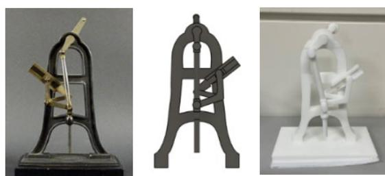
図2 S3「斜めスライダークランク直線リンク機構」
