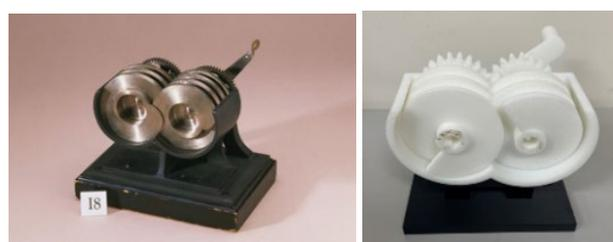
図4 I8「リベリオンチャンバースクリューホイール機構」
