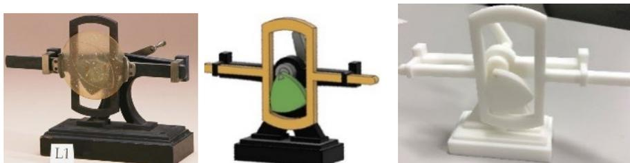
図2 曲線三角形とポジティブリターン機構：後方にあるクランクの回転運動により、ルーローの三角形(定幅図形)が回転し、2本の平行な枠に接触することで枠が水平方向に往復運動する機構
