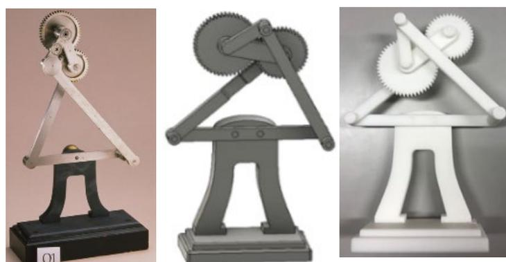
図3. 四節リンク機構と遊星歯車：1つの歯車が固定され、もう1つの歯車とその周りを回転する機構
