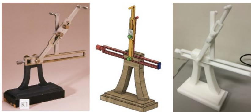
図4. 単純、交差、スライダキネマティックチェーン：スライド軸と回転軸が垂直であり水平になっているリンクが水平方向に前後する機構
