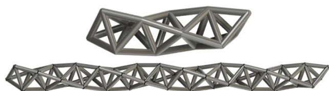
図 1 BCH 試験片（上：10 連結，下：40 連結）
