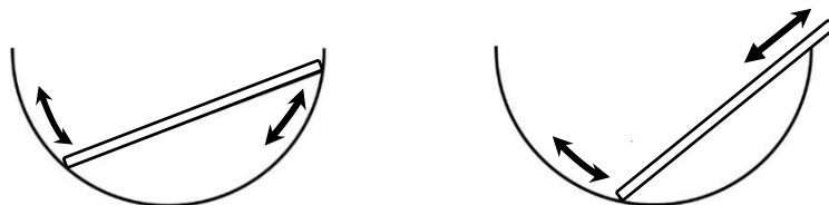
図1 半球内で棒が滑る振り子運動 (1)棒の両端が接地する場合 (2)棒の一端のみ接地する場合
