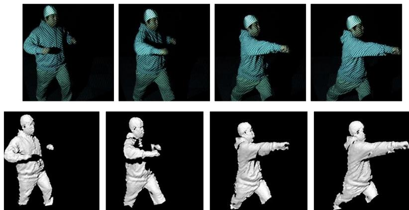
図8：単色波線グリッドパターンを用いた人物の三次元形状計測
