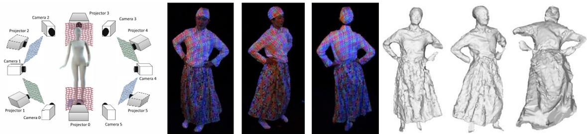
図 9：全周囲形状計測システム：(左)機器構成、(中)入力画像、(右)計測結果。
