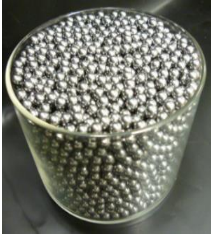
図 1 炭素鋼球のランダム充填
