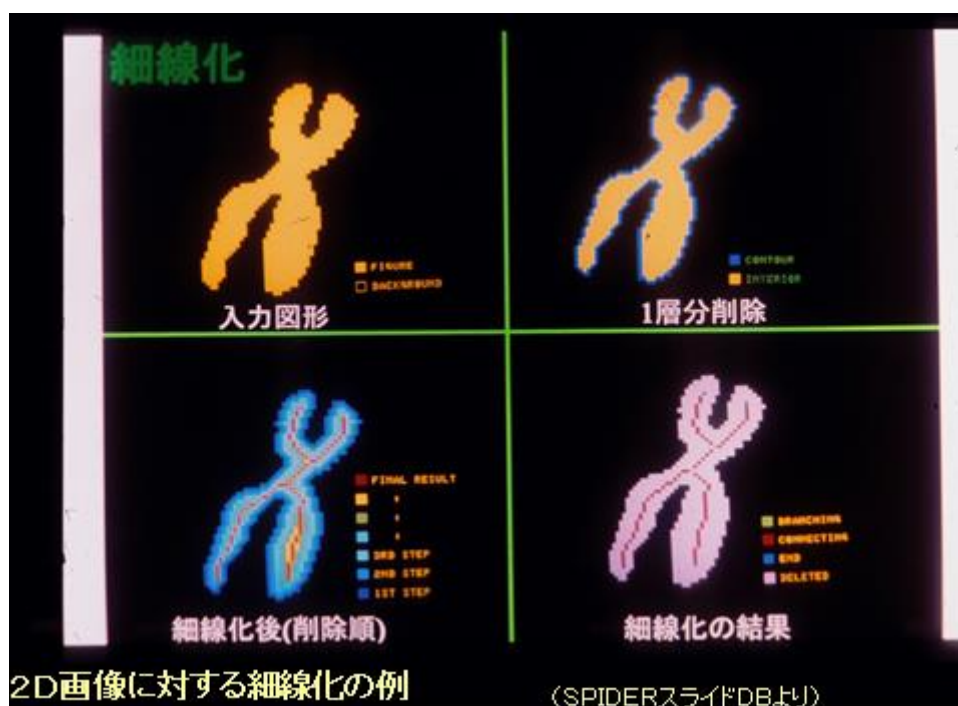
図3 2次元デジタル図形の反復的細線化の例。
