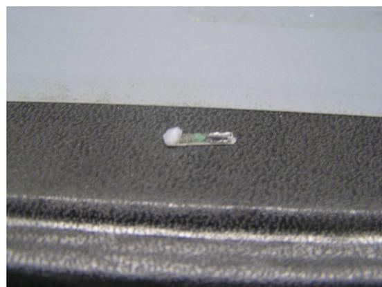
図 3 エッチング後の多層膜（水色）
