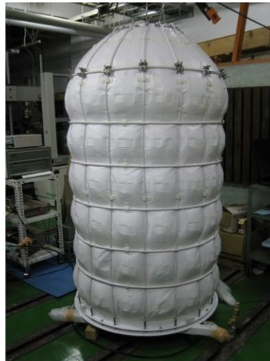
図 2 試作品膨張試験
