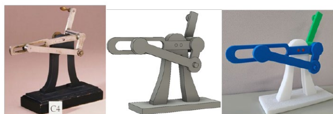
図1 C4 高次対偶のスライダークランク機構 (左)ルーロー模型、(中)3D形状データ、(右)実体化模型
