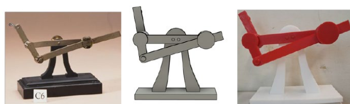
図2 C5 スライダークランク機構 (左)ルーロー模型、(中)3D形状データ、(右)実体化模型
