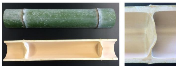
図 1. 竹の長手方向の断面写真。空洞部分の両端が節板で区切られている。各々の節板は、横からの外力に抗うための補剛板の役目を果たす[2]。
