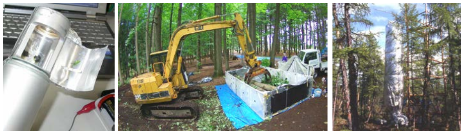
図-1. 自作の装置による芽生え～大木の個体呼吸測定の様子 全て同じ CO 2 センサーと同じ測定原理を用いた。右図は切断しない立木を用いたが、切断して場合も個体呼吸への影響はなかった。
