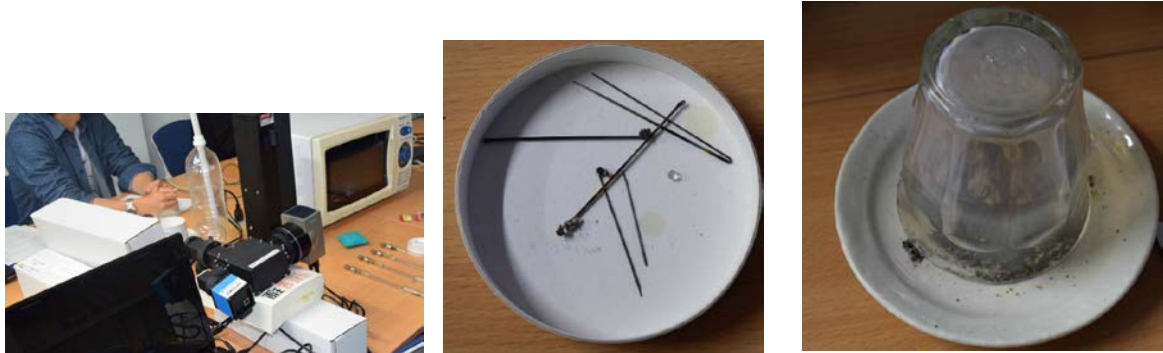
図1：(左) 実験に用いた電子レンジが右上，中央に分光器がある．(中央) アンテナとして用いたシャープペンの芯と待ち針．シャープペンの芯は両端がやせ細り，待ち針の両端は高温で溶けて固まりができています．(右) アンテナとして用いるシャープペンの芯や待ち針を高温に耐えられる陶器の皿にのせ，耐熱コップをかぶせて，プラズマ閉じ込めの容器とする．
