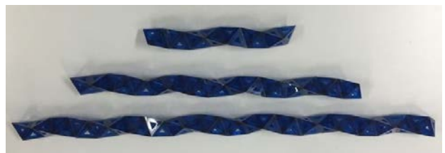
図 6 アクリル製の BCH 試験片 上：20 連結、中：40 連結、下：60 連結
