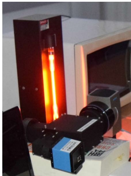
図1：(左) 実験に用いたガス管．大まかの大きさを示すため右側の白い容器に待ち針を入れた．(右) ガス管が放電する様子．ガス管手前に分光器を設置している．
