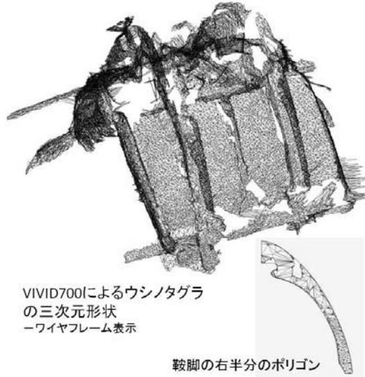
図3 測定された牛荷付鞍の三次元形状
