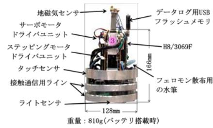
Fig. 1 蟻型ロボットの機能と各モジュール
