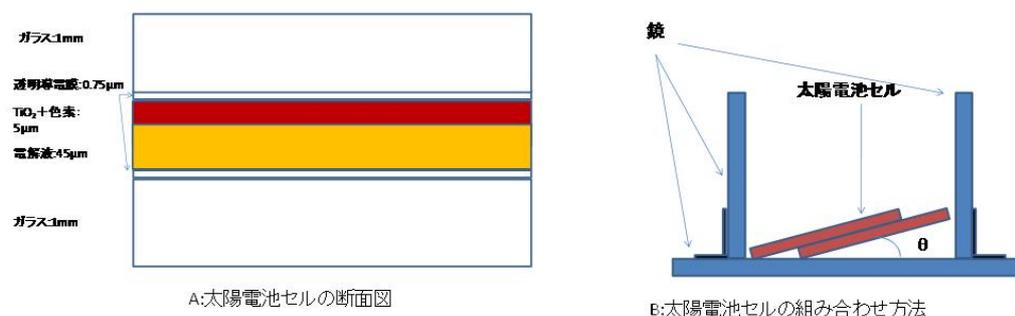
図1 想定した太陽電池セルの組み合わせ A: 太陽電池セルの断面図、B: 太陽電池セルの組み合わせ方法
